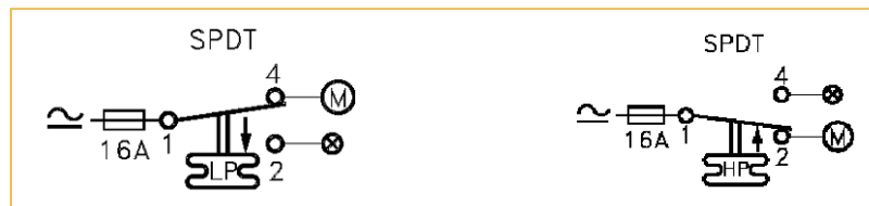
Fig. 46: Esquemas eléctricos de un presostato de baja y otro de alta presión.
