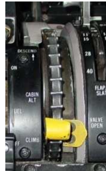
Panel de Control de Presurización
