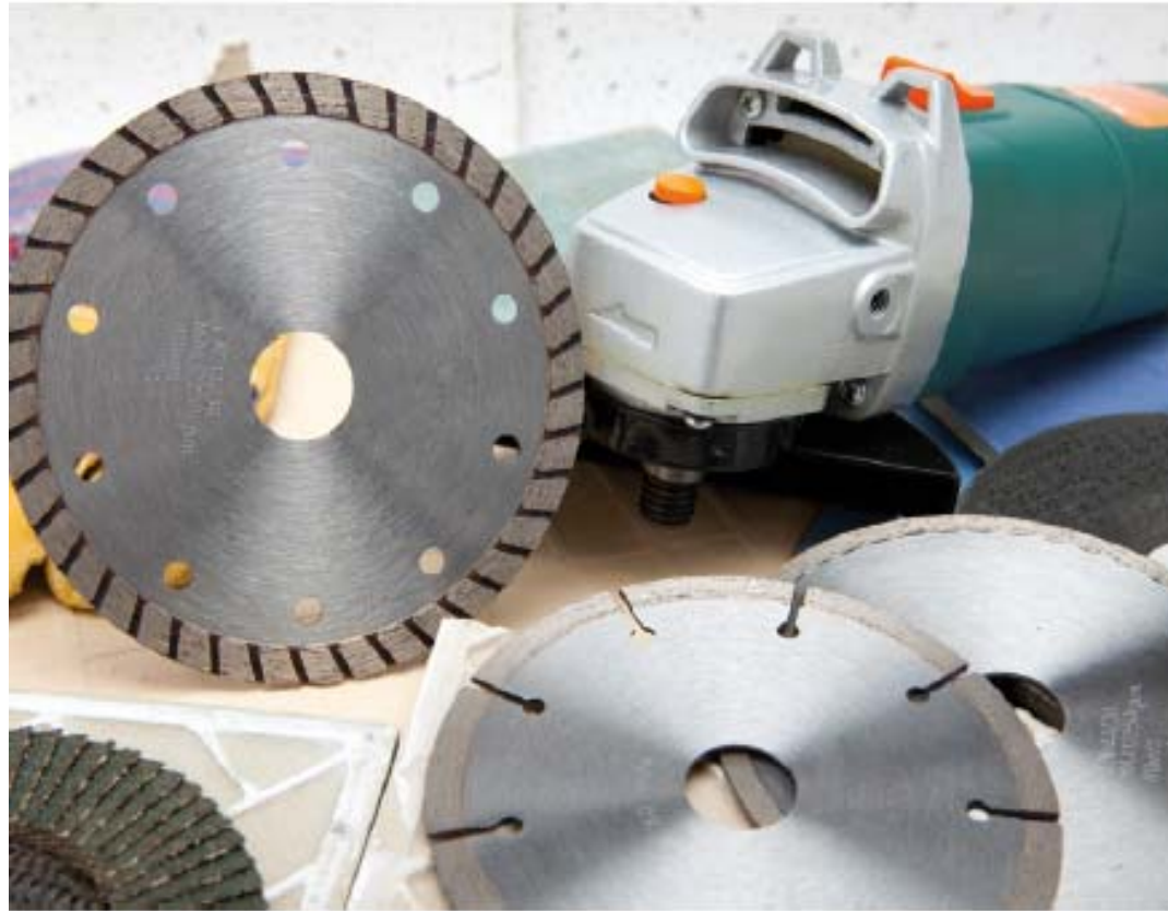
Figura 2.30. Radial con distintos tipos de disco de corte.
