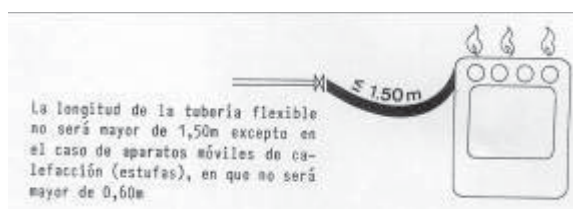
Figura 5.- Longitud Conexión flexible espirometálica
