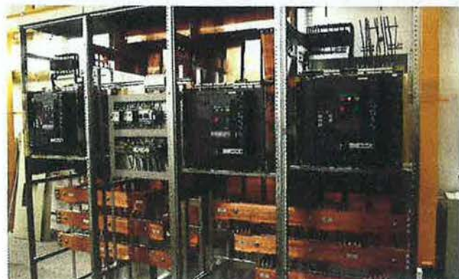
Figura 5.7. Armario de potencia para automatismos con partes ya mecanizadas.
