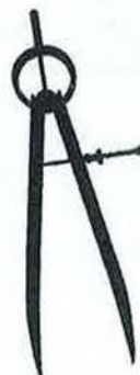
Figura 5.25. Compás de punta para marcar en materiales.
