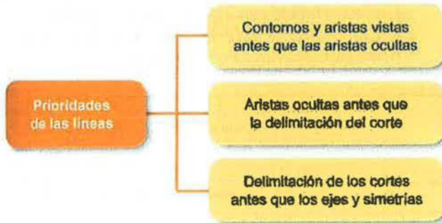
Figura 3.2. Prioridades en caso de coincidencia de líneas en un dibujo técnico.
