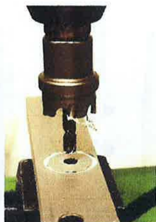
Figura 5.57. Detalle de una perforación de una pieza mediante una fresa.
