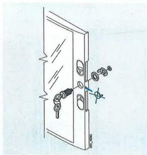
Figura 4.27. Detalle de instalación de una cerradura para cuadro eléctrico. (Cortesía de Siemens.)
