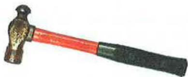
Figura 5.74. Martillo de bola empleado en mecanizado de cuadros eléctricos.
