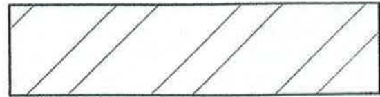
Figura 3.4. Representación del material acero en una sección de una pieza.
