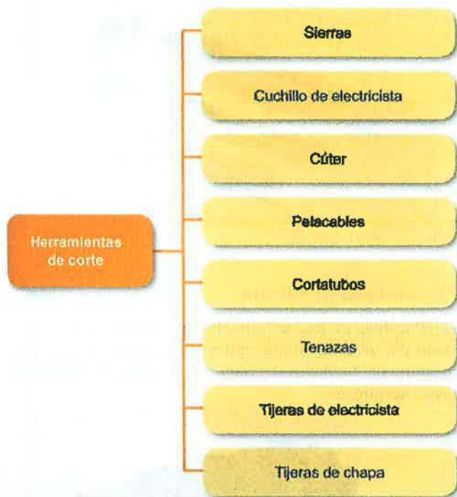
Figura 5.36. Herramientas de corte.
