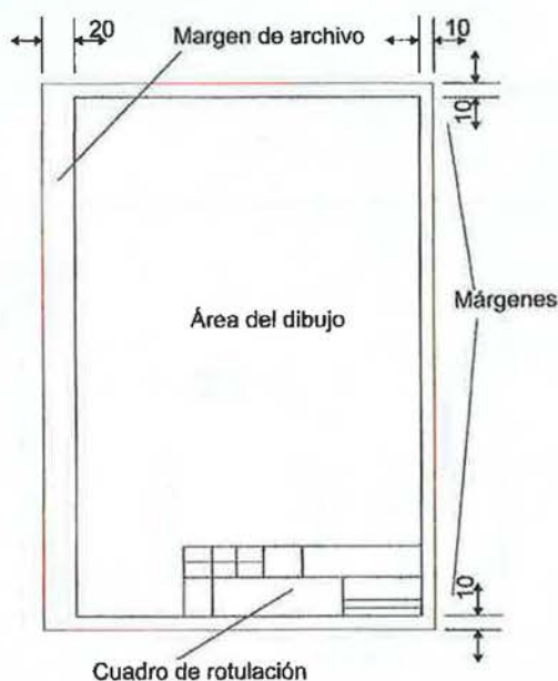
Figura 3.23. Composición de un plano en formato de papel A4.
