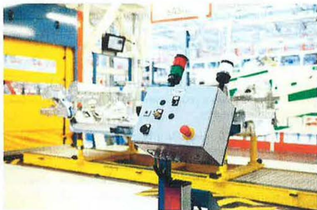
Figura 4.11. Cuadro integrado en máquina.
