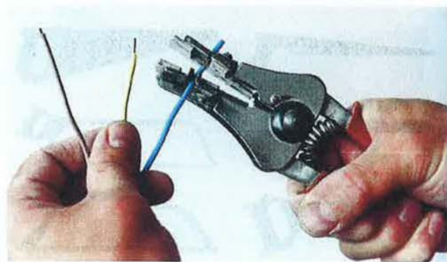
Figura 5.43. Pelacables o pelahilos automático. El cable se coloca en la posición de la sección adecuada extrayendo fácilmente el aislamiento del cable.
