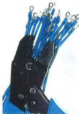
Figura 5.72. Crimpadora de terminales.
