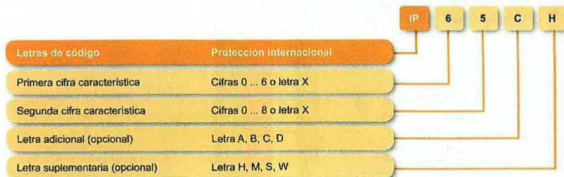
Figura 4.4. Interpretación del índice de protección IP.
