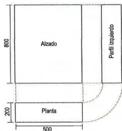
Figura 3.21. Ejemplo de las vistas y cotas mínimas necesarias para definir el cofre de un cuadro eléctrico.
