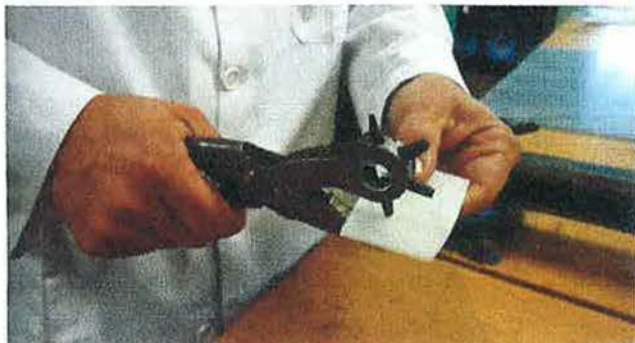
Figura 5.61. Sacabocados para perforar materiales.
