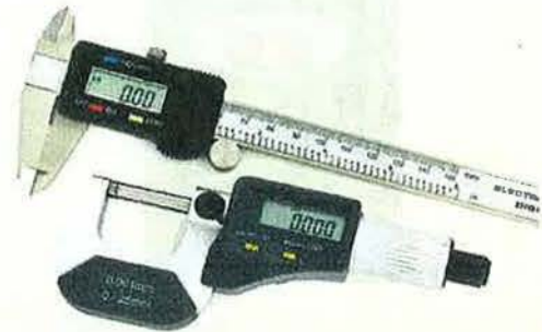
Figura 5.20. Calibre o pie de rey y micrómetro o tornillo de Palmer digitales.
