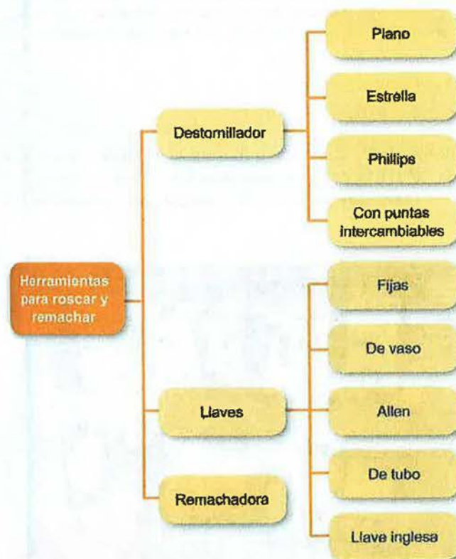
Figura 5.62. Herramientas para fijación de materiales.
