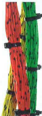
Figura 4.48. Ejemplo de utilización de bridas de plástico para mazas de cables.
