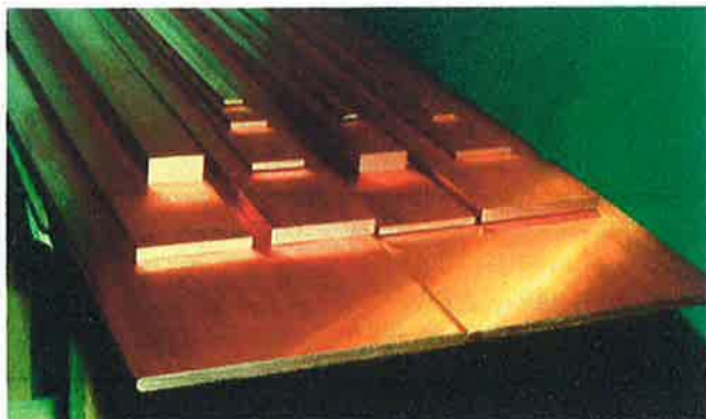
Figura 4.53. Barras macizas de cobre electrolítico.
