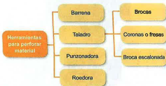
Figura 5.52. Herramientas para perforar material.
