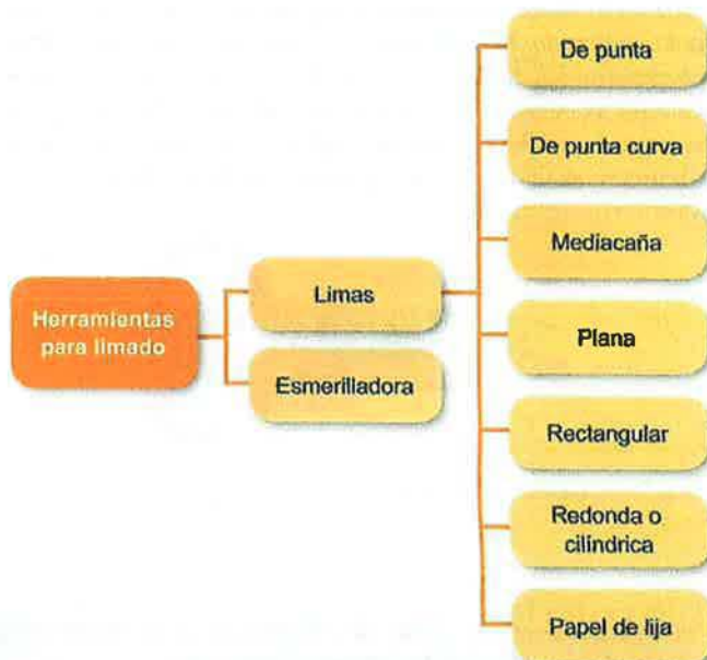
Figura 5.50. Herramientas para limado.
