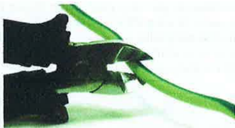
Figura 5.32. Detalle del corte de un cable con un alicate.
