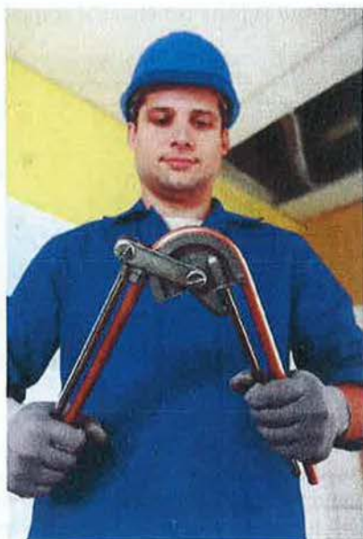
Figura 5.75. Herramienta para doblado de tubos.
