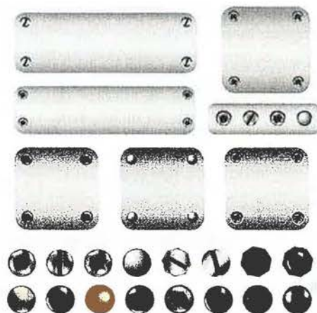
Figura 5.64. Diferentes formas de cabezas para tornillos.
