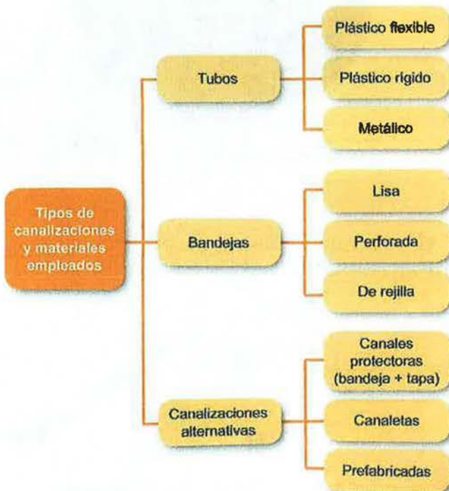
Figura 5.79. Tipos de canalizaciones y materiales empleados
