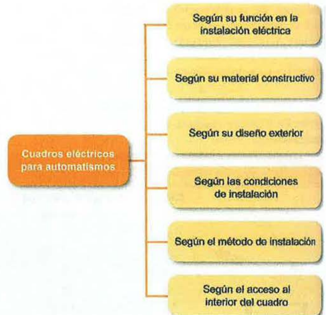
Figura 4.7. Clasificación de los cuadros eléctricos.
