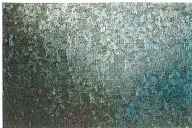
Figura 4.30. Placa galvanizada en bruto para cuadros de automatismos.
