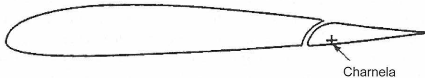
Fig. 35.10 La compensación de Frise se emplea para compensar la guiñada adversa del alerón.
