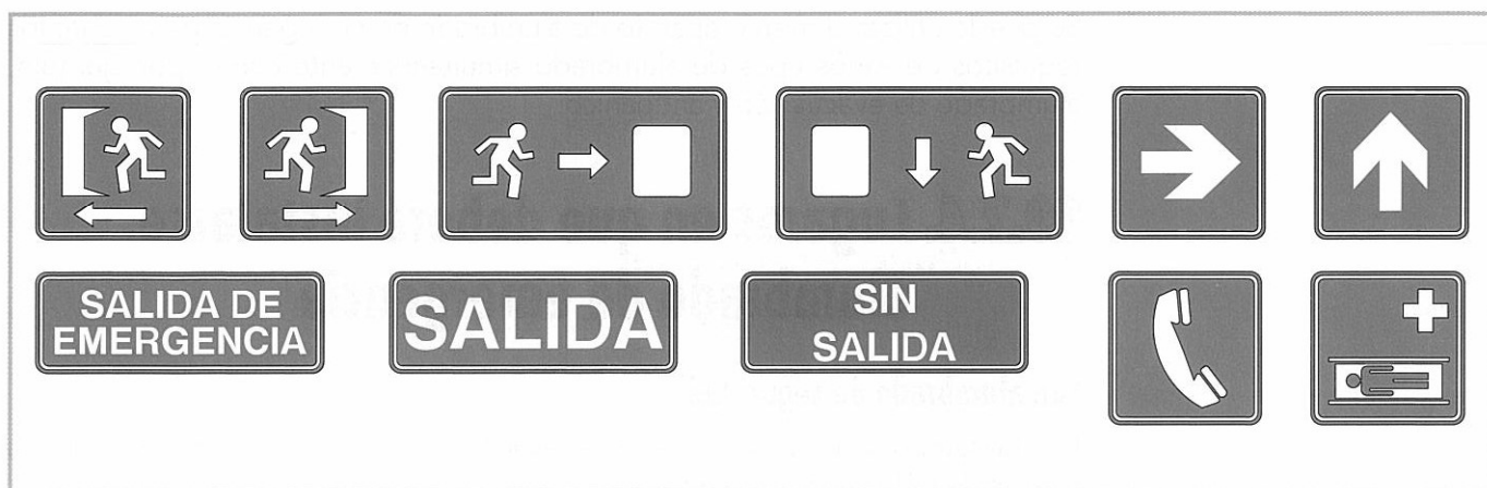
Fig. 10.3. Ejemplos de símbolos normalizados de señalización.
