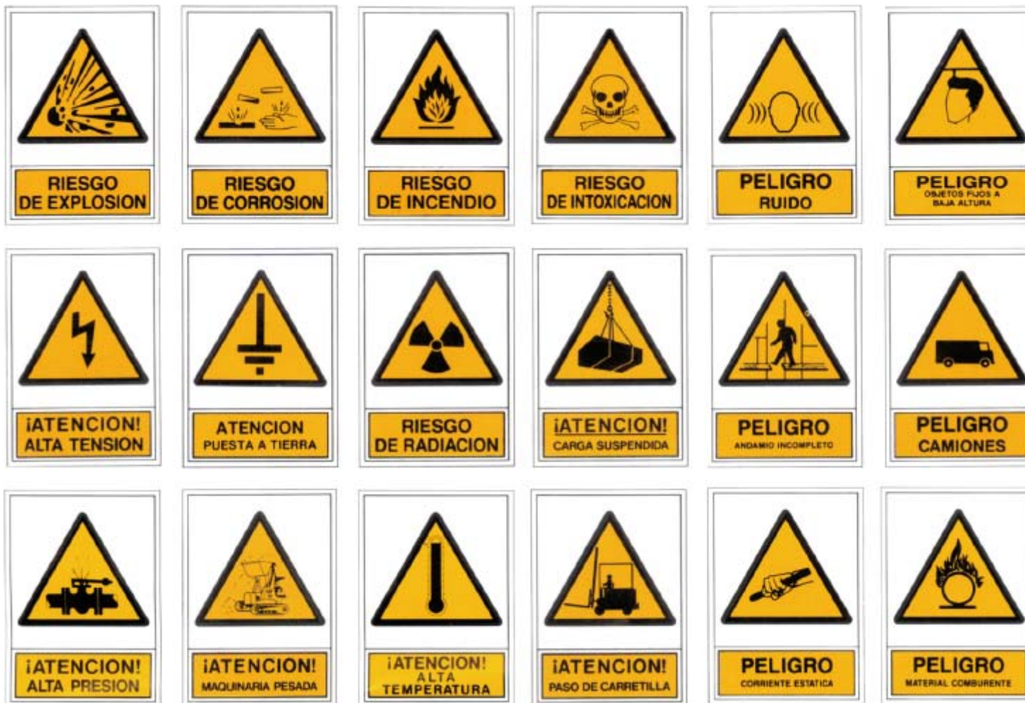
Figura 9.18. Señales de advertencia de peligro.
