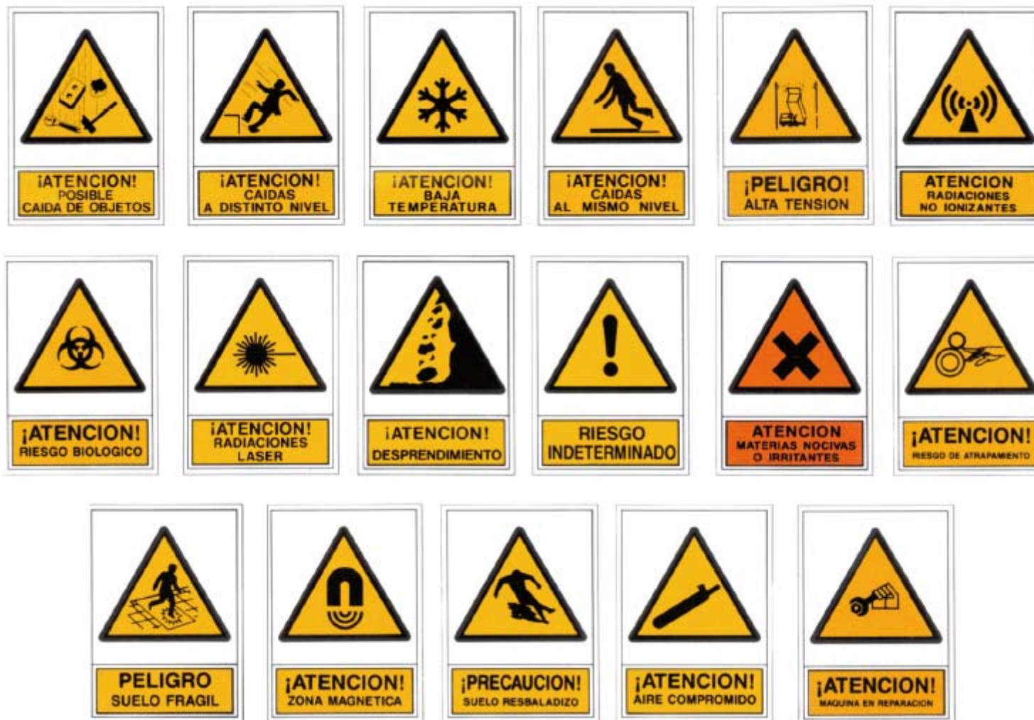
Figura 9.18. Señales de advertencia de peligro.
