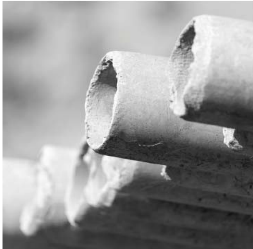
Figura 9.24. Tuberías de fibrocemento con asbesto.
