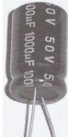
Durante la carga, la corriente sólo circulará en el condensador hasta que el nivel de tensión almacenada alcance la tensión de la batería y durante la descarga, la corriente solo circulará desde el condensador hasta alcanzar los cero voltios (descarga completa).
