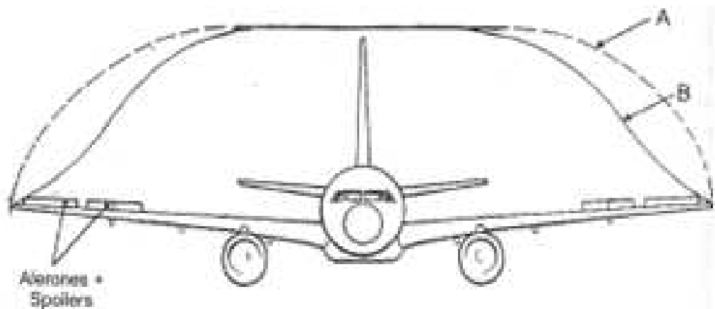
Fig. 35.35 Función Load Alleviation Function (LAF), o alivio de cargas debidas a ráfagas. A Distribución de la carga de sustentación con la función LAF desactivada. B Distribución con la función LAF activada.
