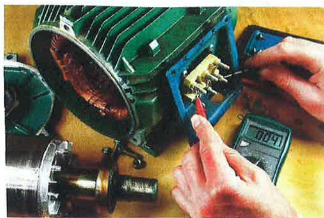
Figura 12.9. Ejemplo de uso del polímetro para realizar medidas de continuidad sobre los devanados de un motor trifásico.
