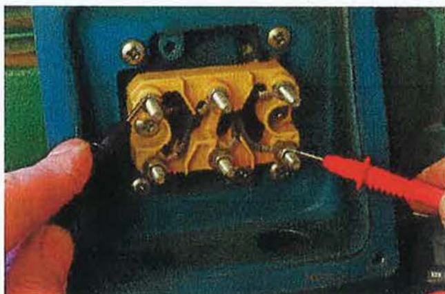
Figura 12.30. Comprobación de la continuidad en los devanados de un motor trifásico para conexión estrella-triángulo.
