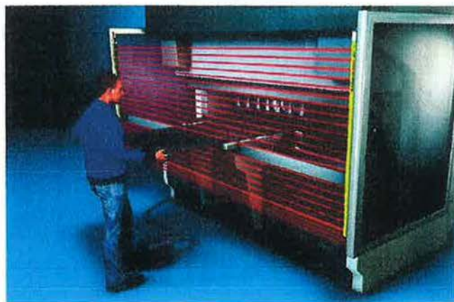
Figura 13.35. Barrera inmateral, también conocida como cortina óptica de seguridad. (Cortesía de Leuze Electronic.)
