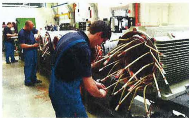
Figura 12.31. Proceso de bobinado de motores trifásicos.
