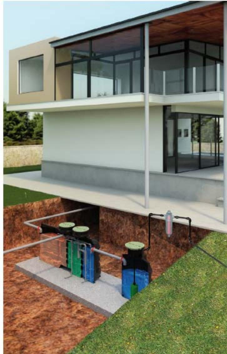
**Figura 6.17.** Diagrama de instalación de fosa séptica. *Cortesía Jimten.*
