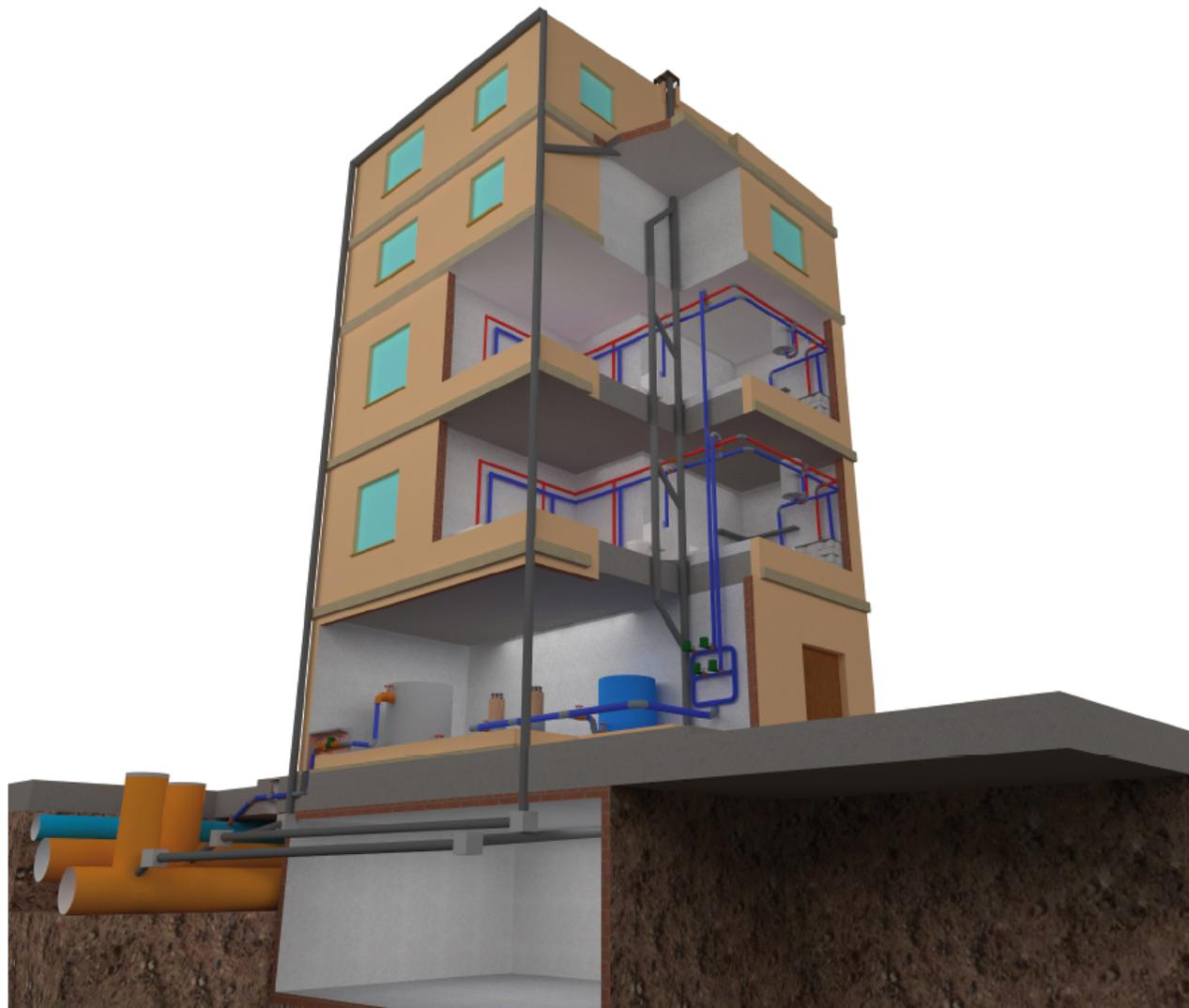
Figura 6.1. Diagrama del sistema de evacuación.
