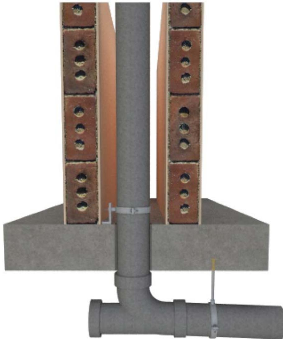
**Figura 6.10.** Detalle de conexión de bajante a colector suspendido.
