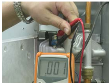
Figura 22 – Comprobación de la continuidad
