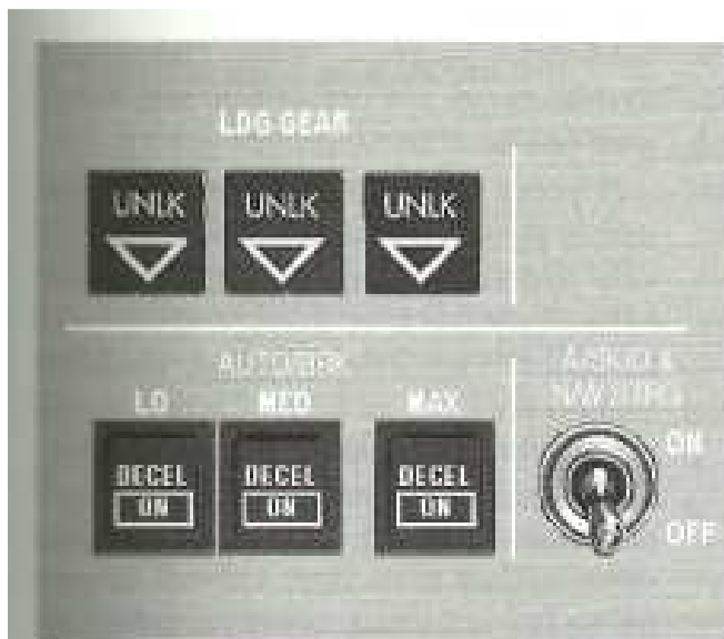
Fig. 34.37 Pulsadores selectores de frenada automática de tres niveles.
