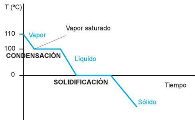
Figura 2.4. Proceso endotérmico. Gráfica cambio de estado condensación y solidificación para el agua
