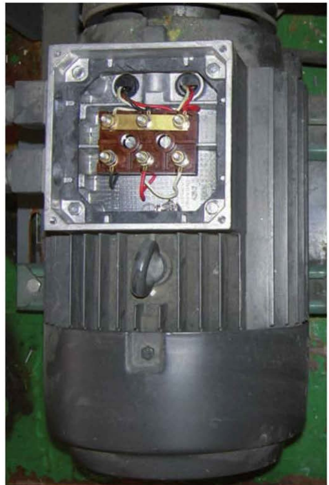
Figura 8.23. Caja de bornas en compresor abierto
