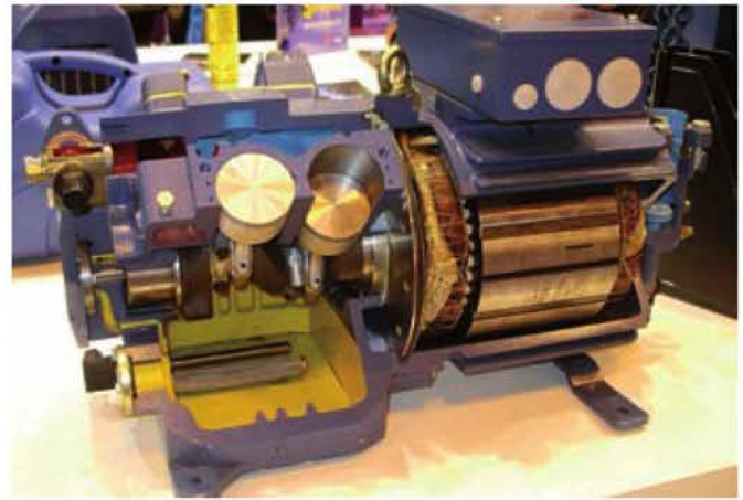
Figura 8.9. Sección de compresor alternativo
