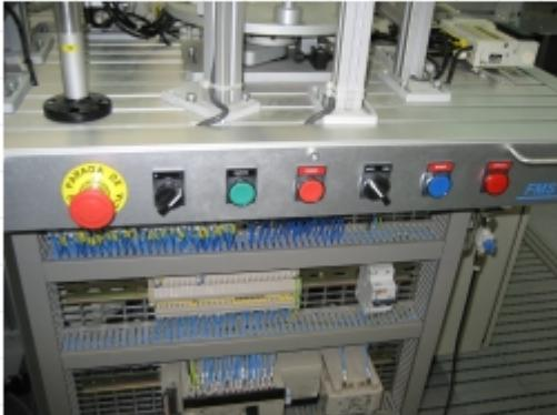
Los órganos de accionamiento de un equipo de trabajo que tengan alguna incidencia en la seguridad deberán ser claramente visibles e identificables, cuando corresponda, estar indicados con una señalización adecuada. En el siguiente ejercicio se analizarán estas cuestiones.
