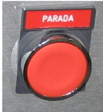
Cada equipo de trabajo deberá estar provisto de un órgano de accionamiento que permita su parada total en condiciones de seguridad. Completa el siguiente ejercicio sobre ello.
