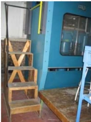
Si fuera necesario para la seguridad o salud de los trabajadores, los equipos de trabajo y sus elementos deberán estabilizarse por fijación o por otros medios. Se va a incidir a continuación en ello.
