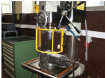
Se trata de resguardos asociados a un dispositivo de enclavamiento de manera que las funciones de seguridad de la máquina cubiertas por el resguardo no pueden desempeñarse hasta que el resguardo esté cerrado. La apertura del resguardo supone la orden de PARADA, mientras que su cerrado no provoca la puesta en marcha de la máquina.
