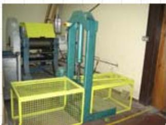
Los resguardos son elementos de una máquina utilizados específicamente para garantizar la protección mediante una barrera material. Dependiendo de su forma, un resguardo puede ser denominado carcasa, cubierta, pantalla, puerta, envolvente, etc.
