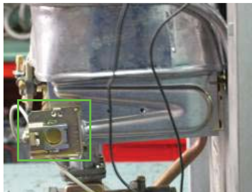
Figura 13.7 – Situación de la rampa de inyectores.
