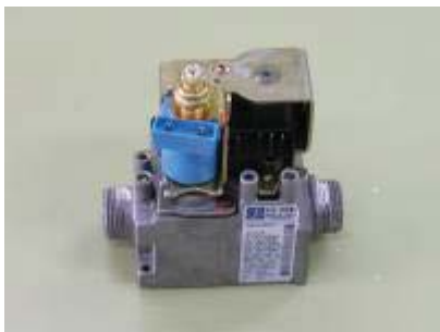
Figura 13.3 – Válvula de gas SIT modelo SIGMA 845 desmontada.
