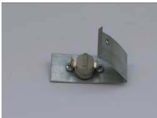
Figura 13.24 – Sonda antidesbordamiento de PdC.
