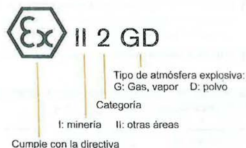
Figura 6.66. Interpretación del marcado ATEX.
