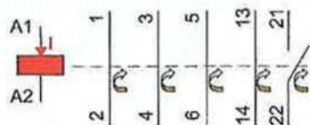
Figura 7.7. Representación gráfica del contactor activado.
