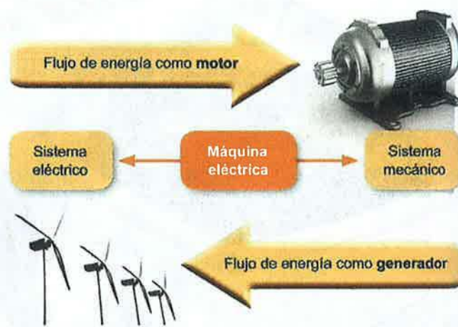
Figura 6.2. Diagrama funcional de clasificación de las máquinas eléctricas rotativas.
