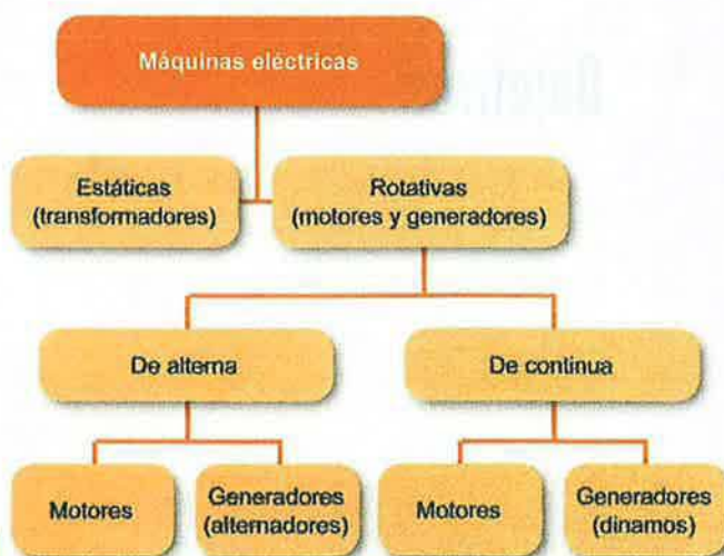
Figura 6.1. Clasificación de las máquinas eléctricas.
