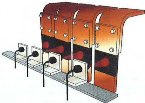
Figura 7.57. Detector de temperatura de embarrados. (Cortesía de Siemens.)
