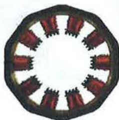
Figura 6.6. Sección en alzado de un estator.
