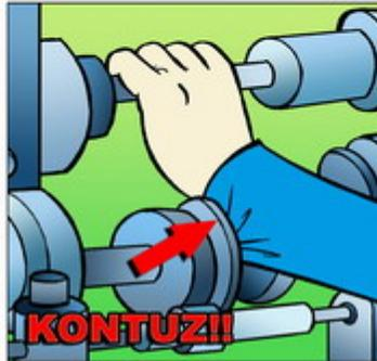
Los atrapamientos de cualquier parte del cuerpo se producen principalmente en las partes móviles de las máquinas. Las causas más comunes de este tipo de accidentes son:
