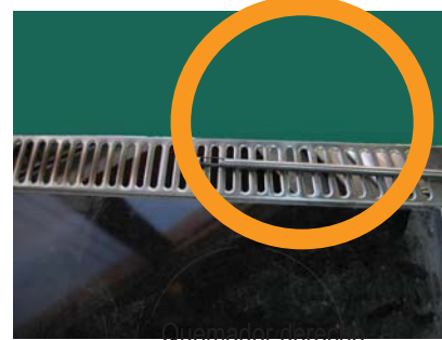
Figura A | 4- Toma de productos de la combustión. Vitrocerámicas de fuegos cubiertos.
