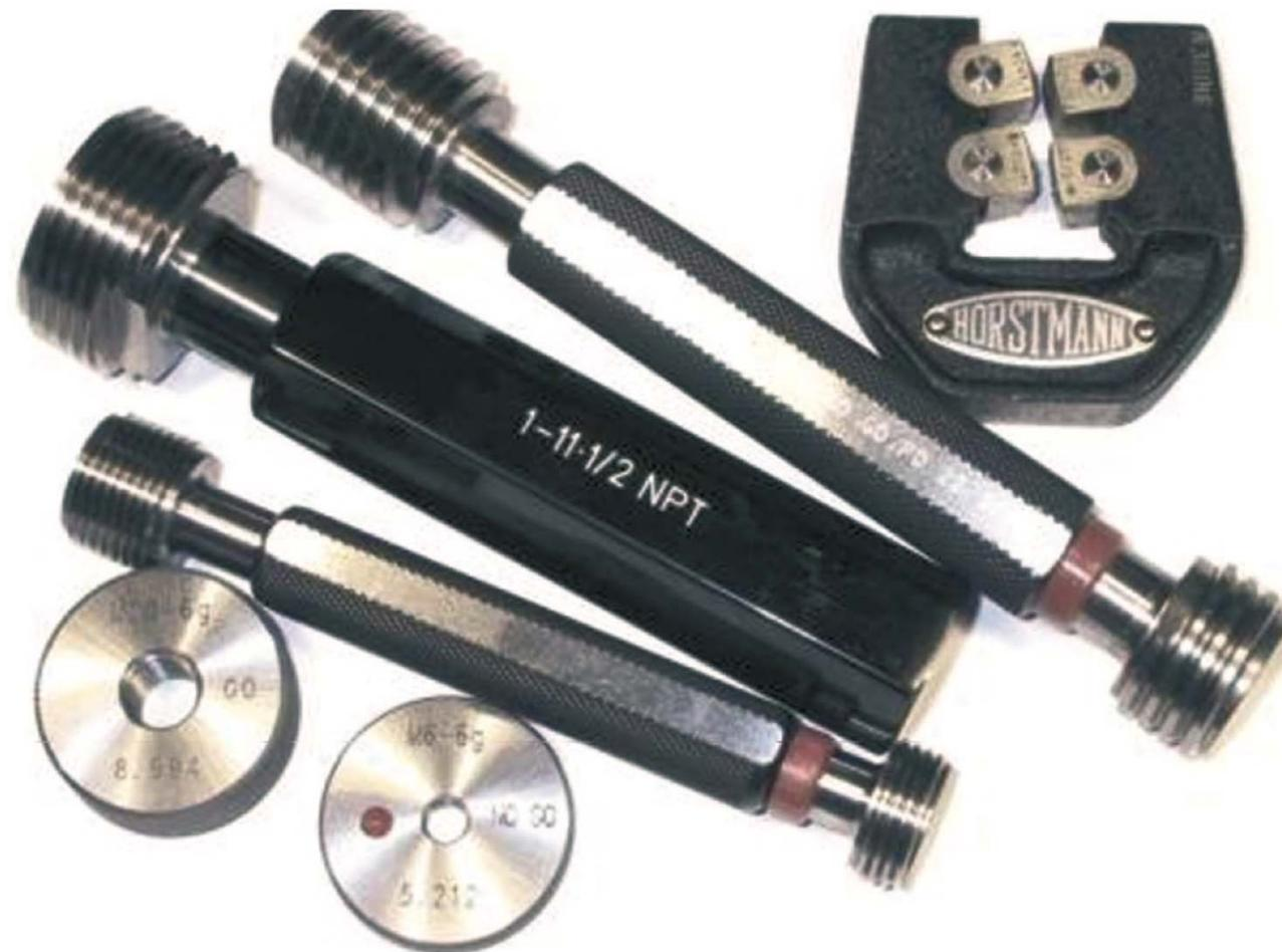
Figura 4.72. Útiles de comprobación de roscas.
