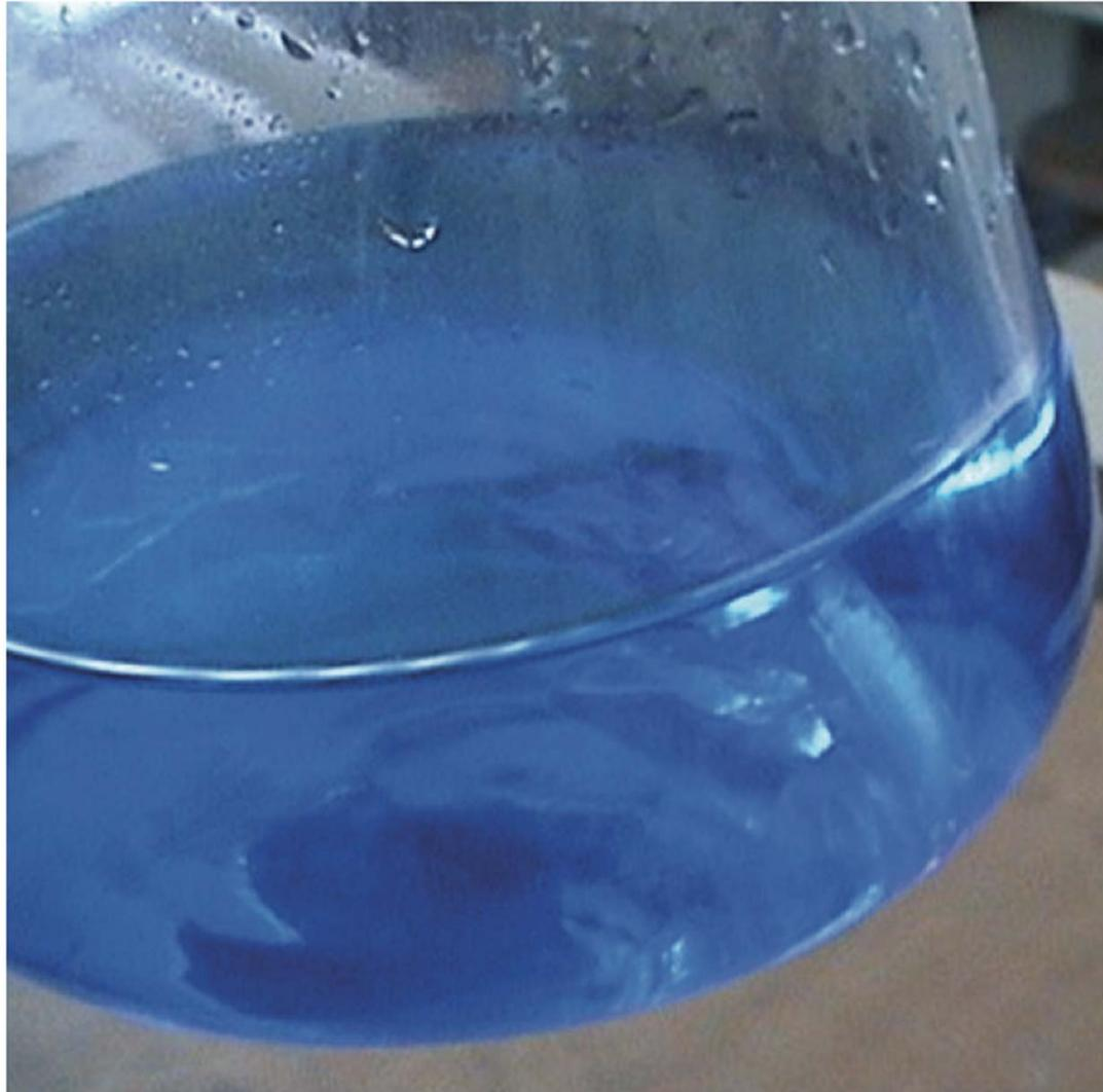
**Figura 4.9.** Sulfato de cobre utilizado como cubriente.
