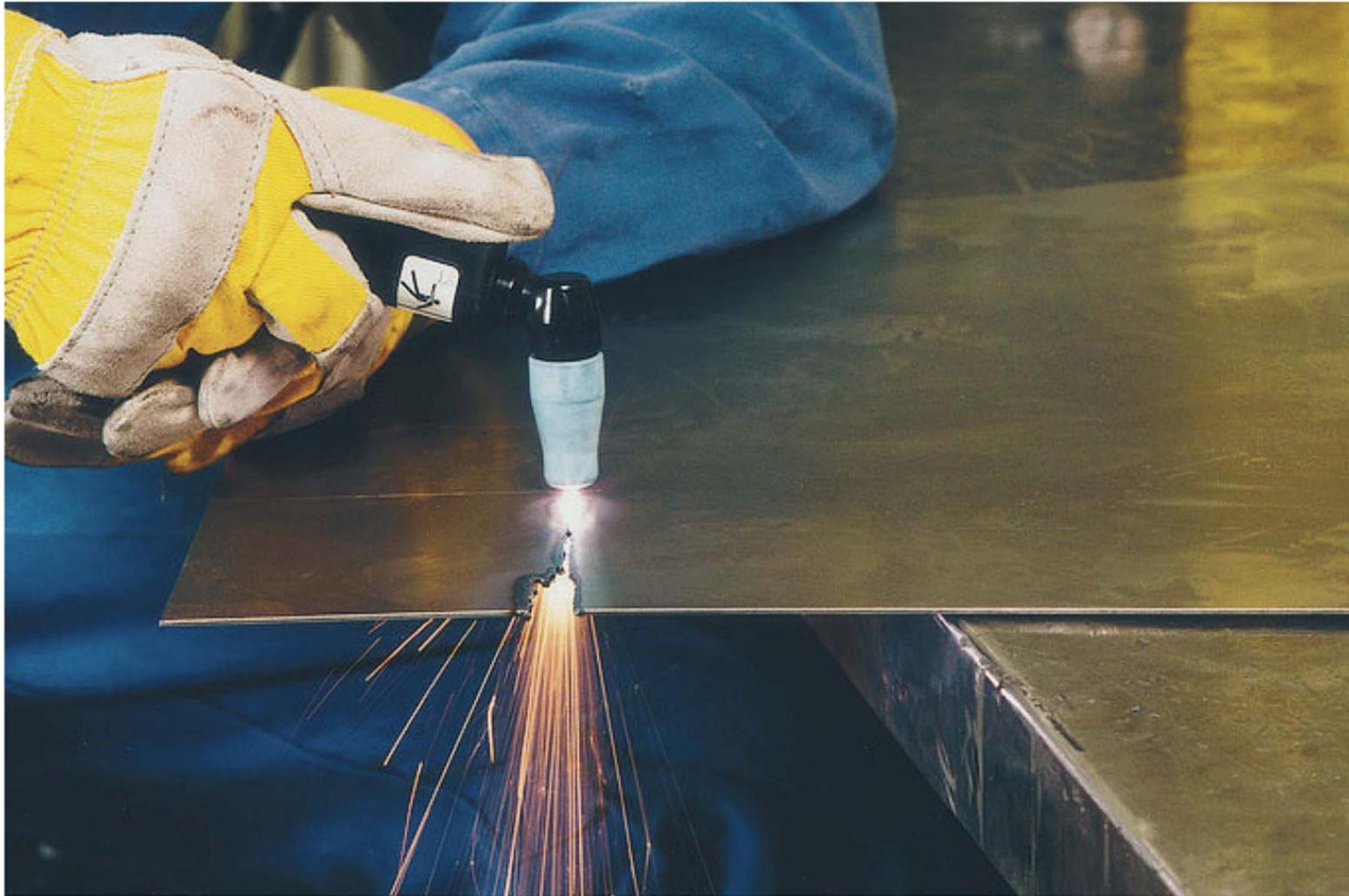
**Figura 4.41.** Proceso de corte por plasma.
