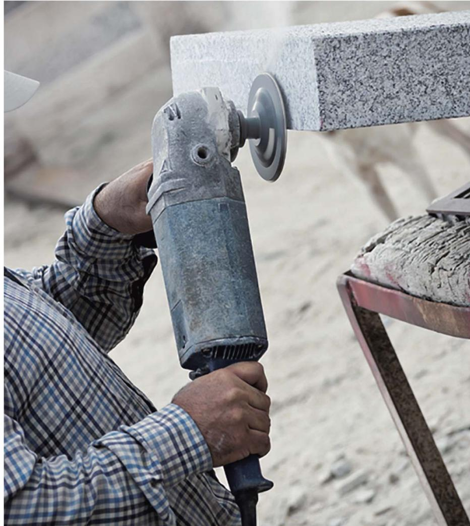
**Figura 4.28.** Radial con disco de pulido.
