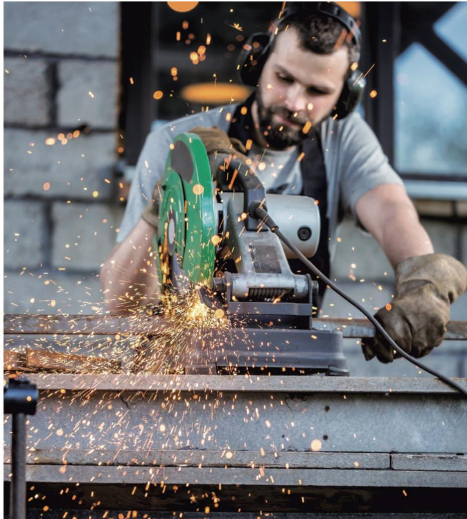
**Figura 4.30.** Sierra circular o tronzoadora cortando metal.
