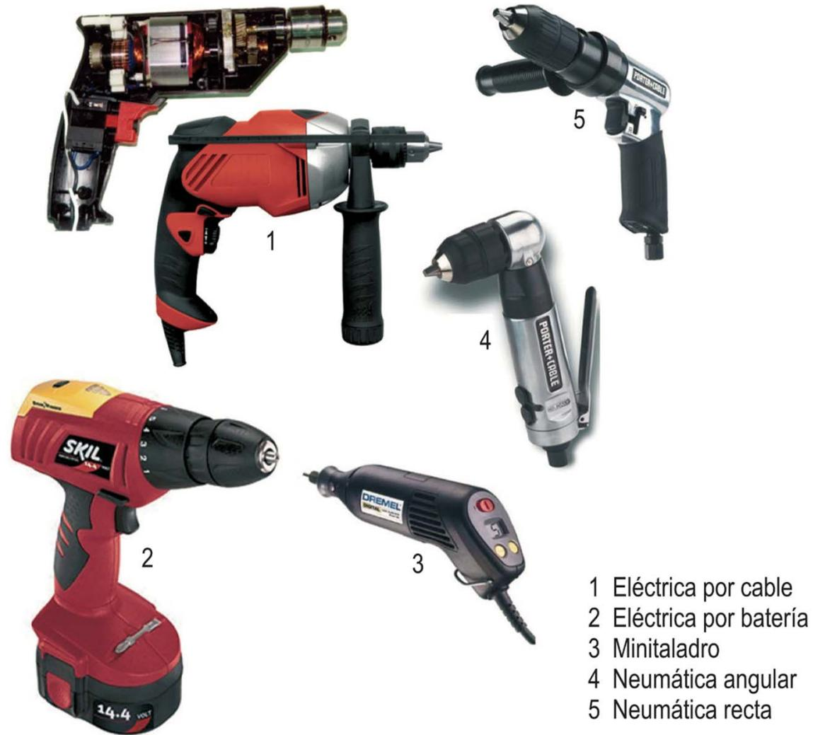
Figura 4.58. Diferentes tipos de taladradoras portátiles.
