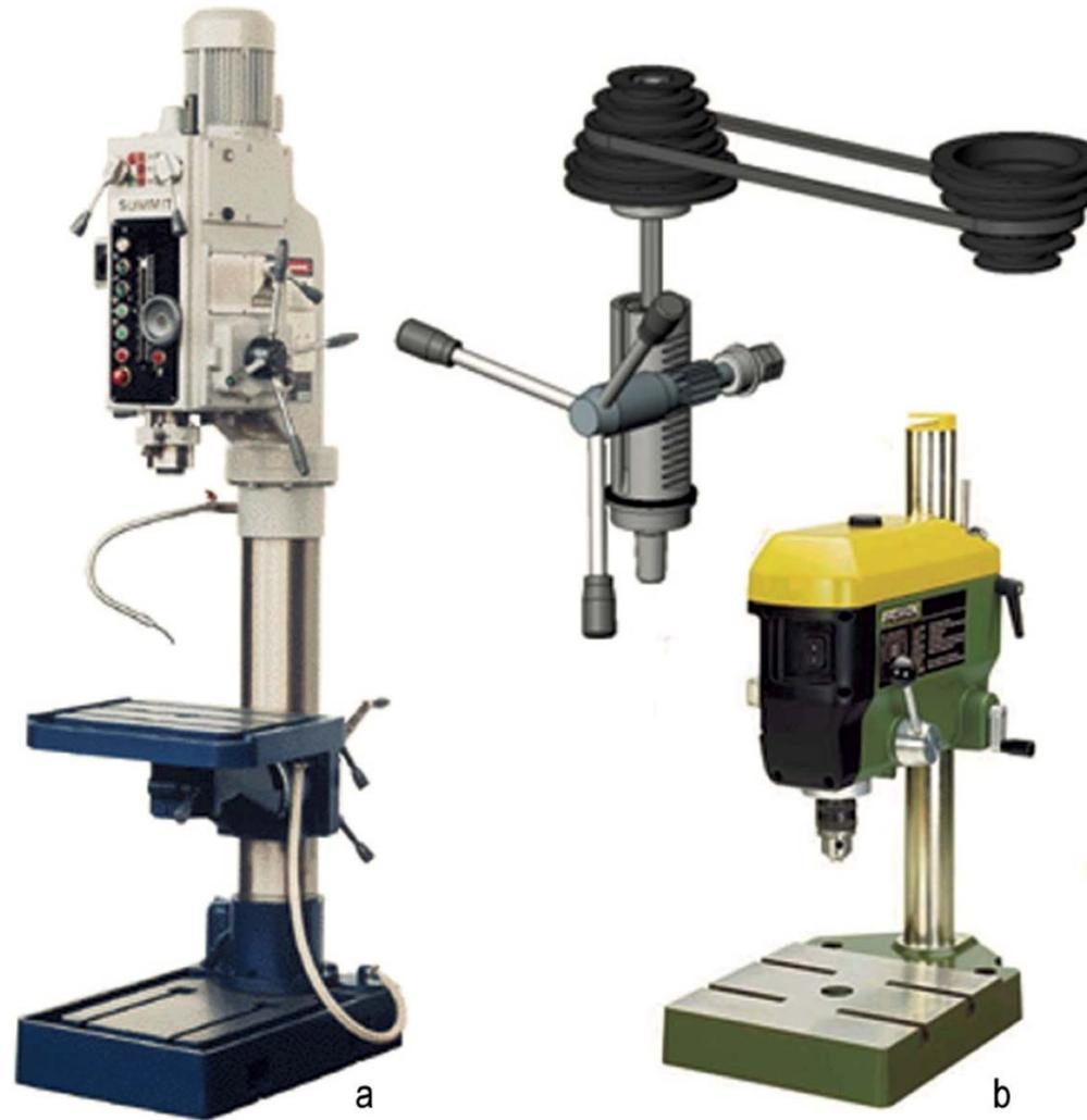
**Figura 4.62.** a) Taladradoras de columna; b) detalle de caja de velocidades.
