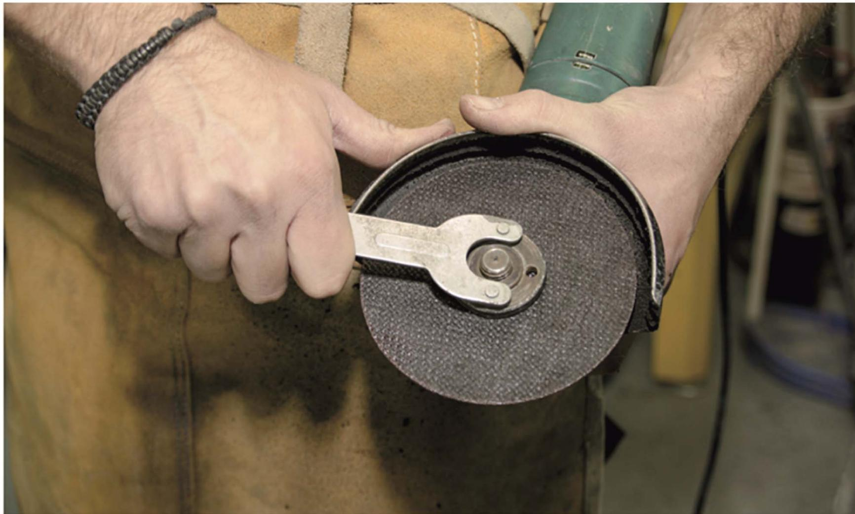
**Figura 4.29.** Detalle de montaje de disco con llave especial de radial.
