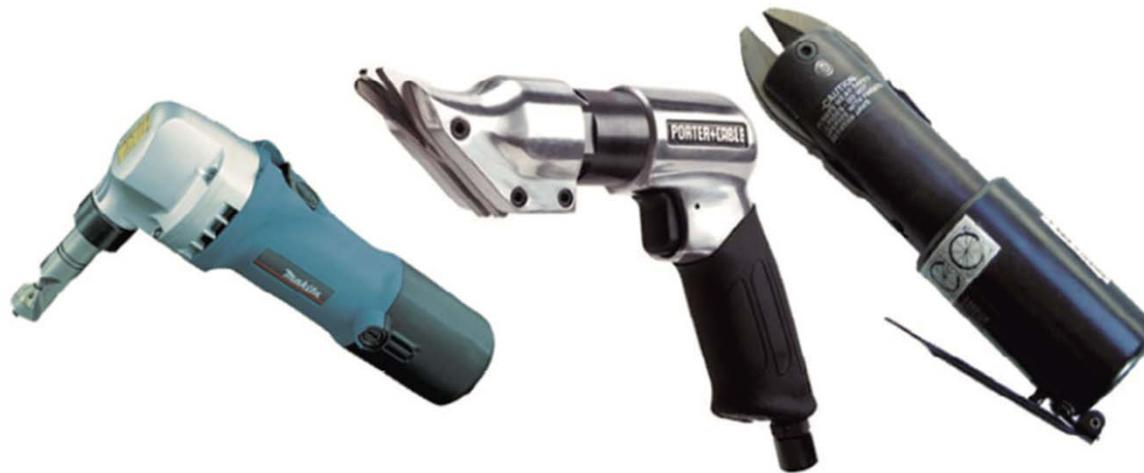
**Figura 4.35.** Roedora y cizallas neumáticas.
