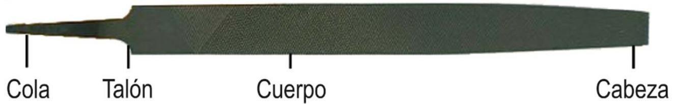
**Figura 4.45.** Diferentes partes de una lima.
