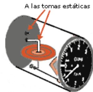
Fig.2.4.2 - Modelo de variómetro.
