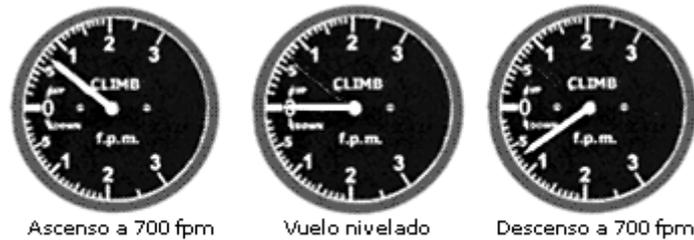
**Fig.2.4.3 - Indicaciones del variómetro.**
