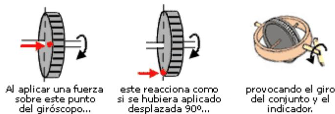
**Fig.2.8.4 - Funcionamiento del indicador de viraje.**
