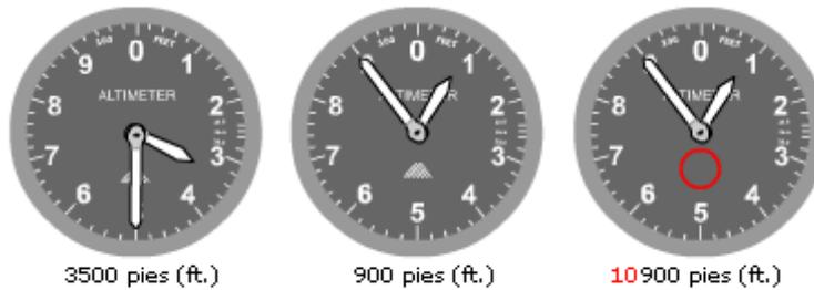
Fig.2.3.3 - Lectura del altímetro de dos agujas.
