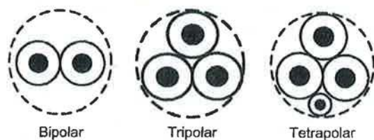
Figura 2.12. Representación gráfica de cables multiconductores.
