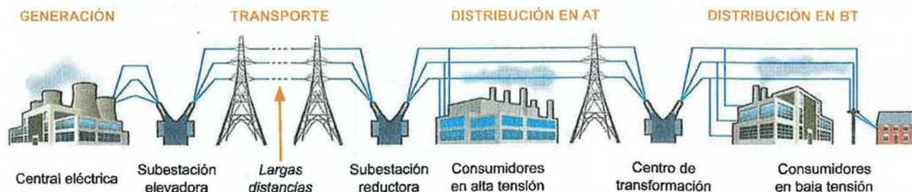
Figura 1.13. Esquema completo del sistema eléctrico nacional desde los puntos de generación hasta las zonas de consumo.
