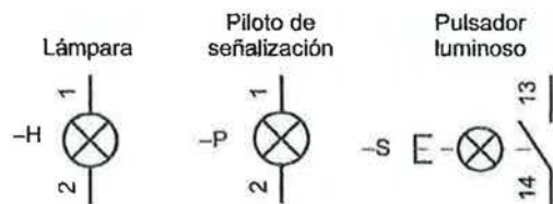
Figura 2.97. Simbología asociada a los receptores luminicos.
