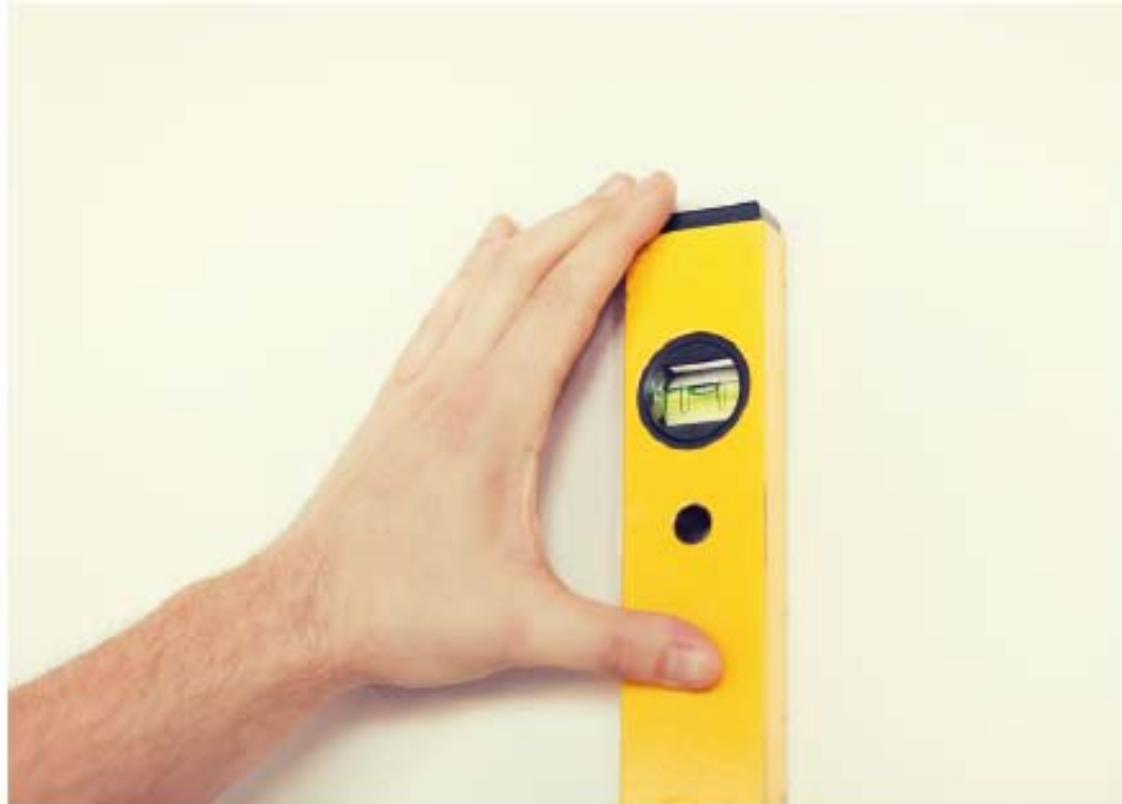
Figura 1.19. El nivel marca la línea vertical con la burbuja centrada.
