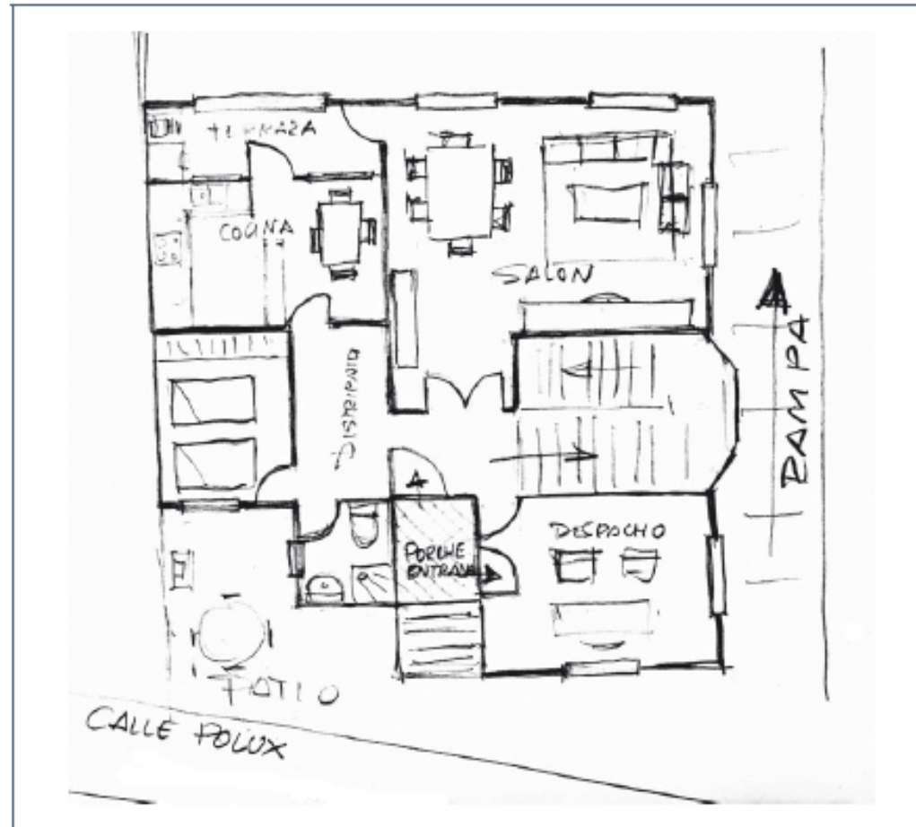
Figura 1.27. Croquis de planta de una vivienda.
