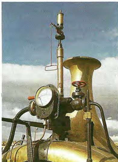
Fig. 7.27. Los manómetros de las instalaciones industriales suelen ser metálicos. Manómetro de una vieja locomotora de vapor.
