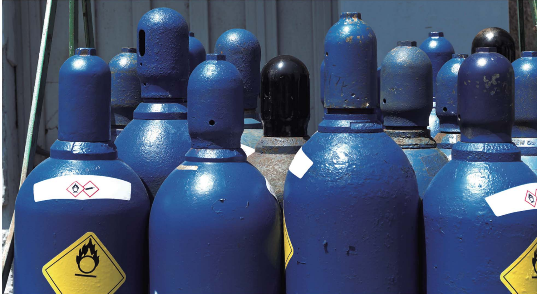
Figura 5.20. Cilindros fabricados mediante embutido.
