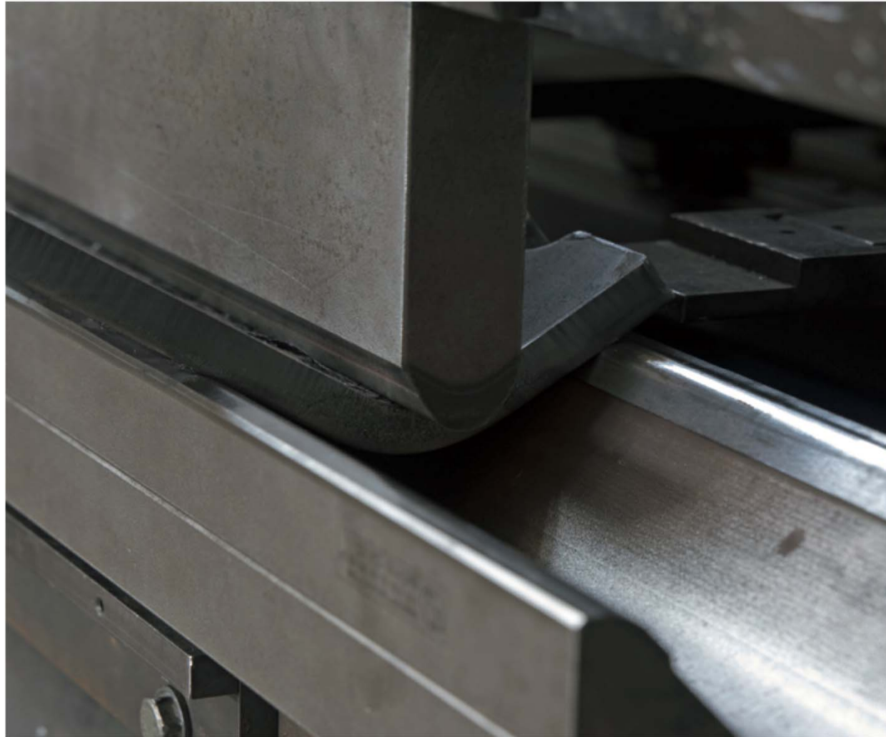
Figura 5.15. Detalle de prensa plegadora.
