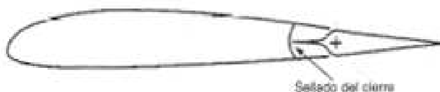
Fig. 35.8 Compensador de Westland-Irving. Es una modificación del compensador Handley Page.
