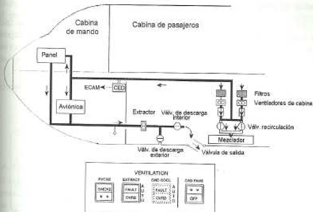
Fig. 37.17 Esquema de sistema de ventilación de avión de gran alcance y amplio volumen de cabina.
