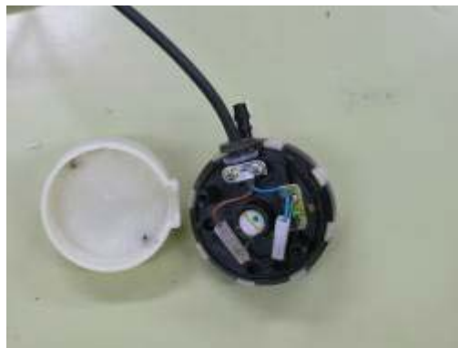
Figura 12.28 – Contactos eléctricos internos del presostato.
