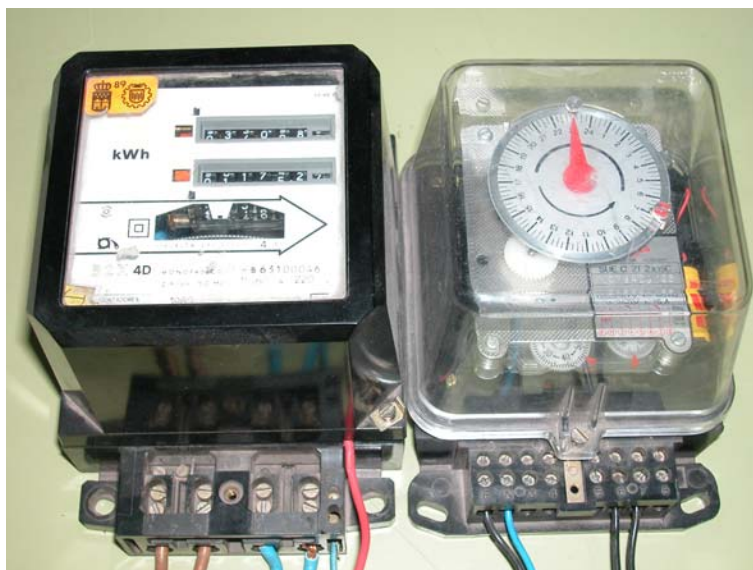
Figura 16 – Contador monofásico de doble tarifa con interruptor horario.
