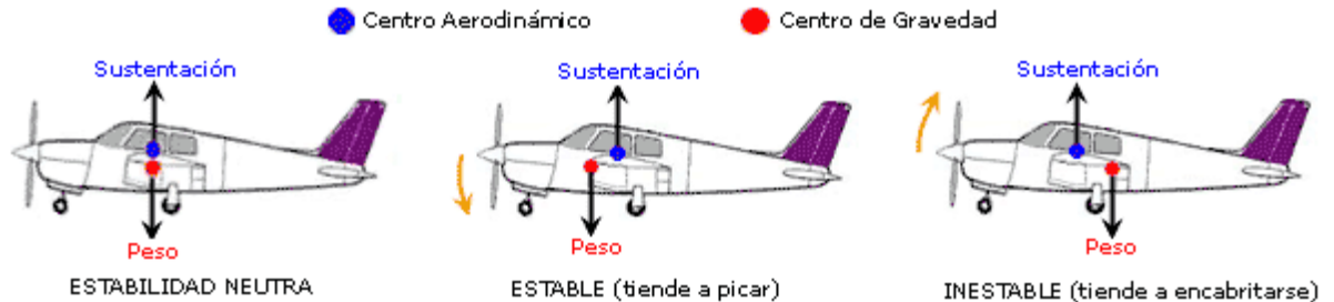
Fig.1.6.10 - Estabilidad longitudinal en función del C.A. y del C.G.
