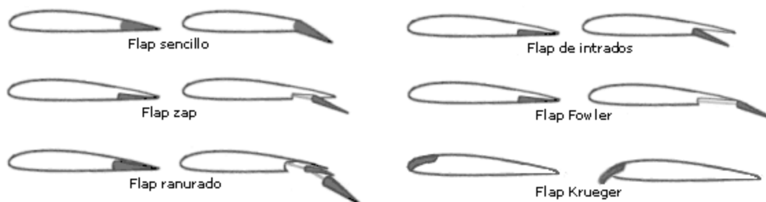
Fig.1.5.9 - Distintos tipos de flaps.
