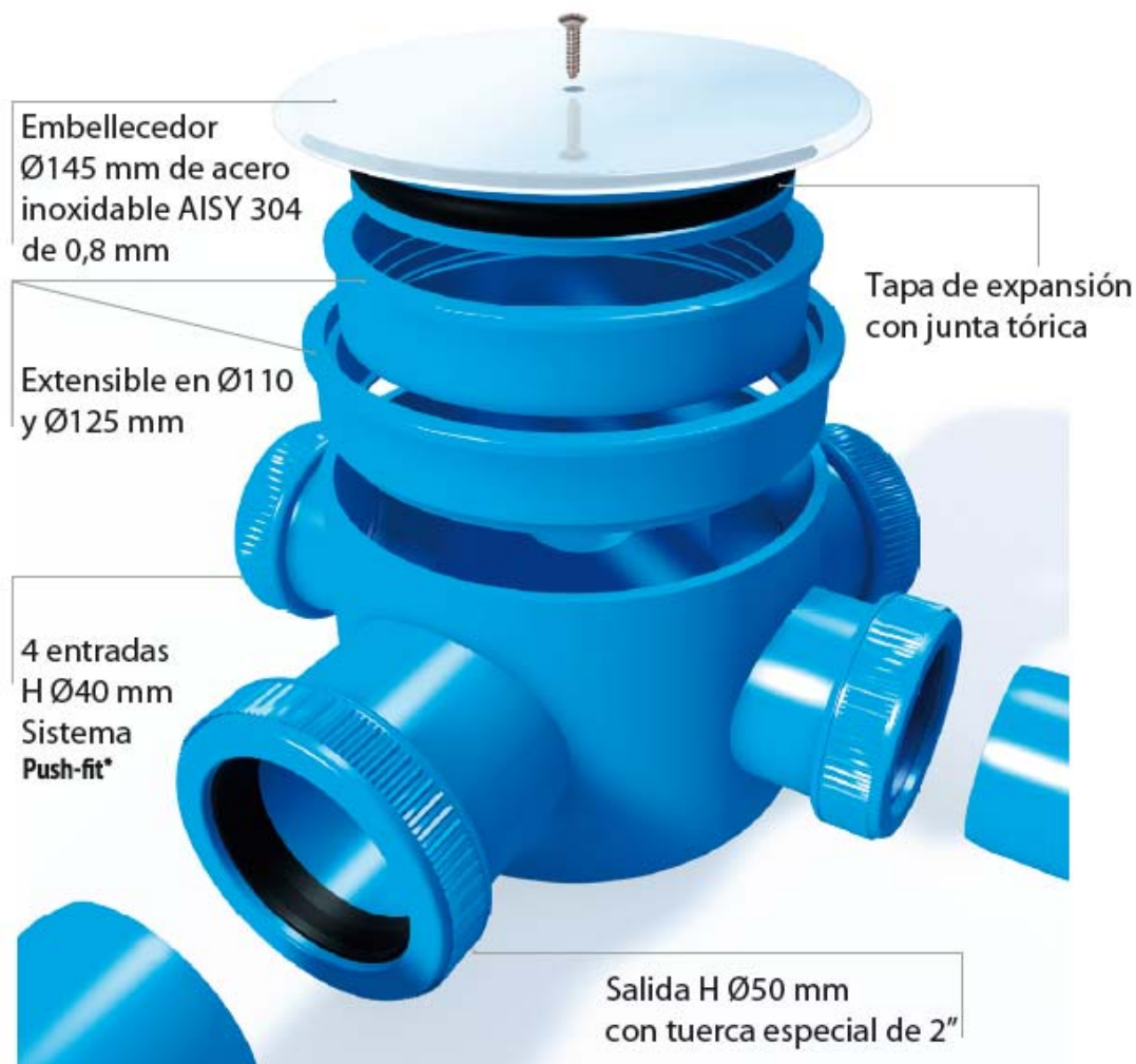
Figura 5.12. Diagrama de bote sifónico con conexión Push-fit. Cortesía de Jimten.
