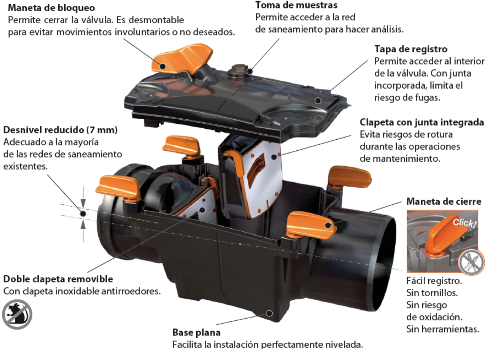
Figura 5.17. Diagrama de construcción de una válvula antirretorno. Cortesía de Jimten.
