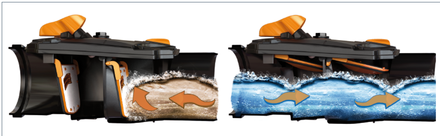
Figura 5.18. Diagrama de funcionamiento de válvula antirretorno impidiendo el paso de roedores y aguas retornadas. Cortesía de Jimten.
