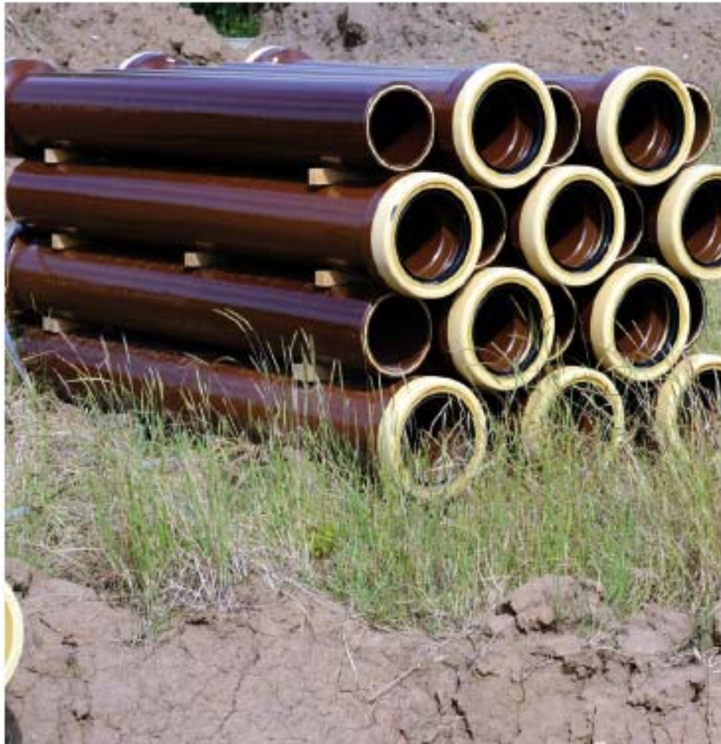
Figura 5.8. Tuberías de gres vitrificado.
