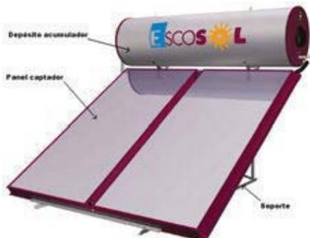
Estos equipos funcionan calentando en un captador solar el agua que circula por dentro de un circuito cerrado (circuito primario), que actúa como fluido térmico, y a la que se le añade generalmente algún tipo de anticongelante. Dentro de un tanque acumulador, y con ayuda de un intercambiador de calor, se calienta el agua potable que será utilizada posteriormente por el consumidor.
