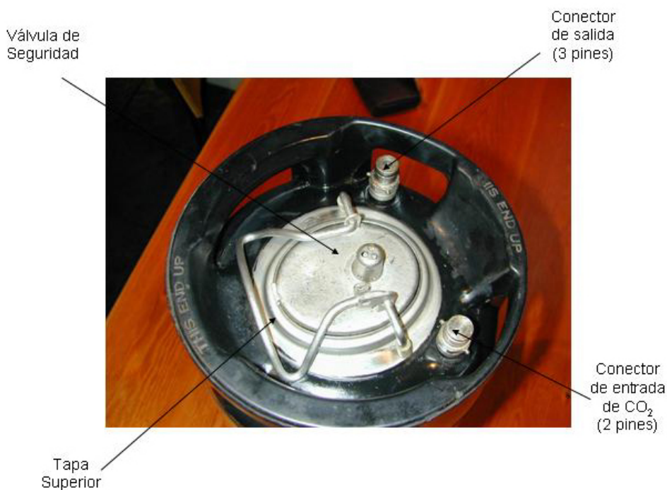
Figura 2 - Vista superior del tanque (Pin-lock)
