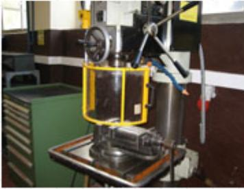
Se trata de resguardos asociados a un dispositivo de enclavamiento de manera que las funciones de seguridad de la máquina cubiertas por el resguardo no pueden desempeñarse hasta que el resguardo esté cerrado. La apertura del resguardo supone la orden de PARADA, mientras que su cerrado no provoca la puesta en marcha de la máquina.
