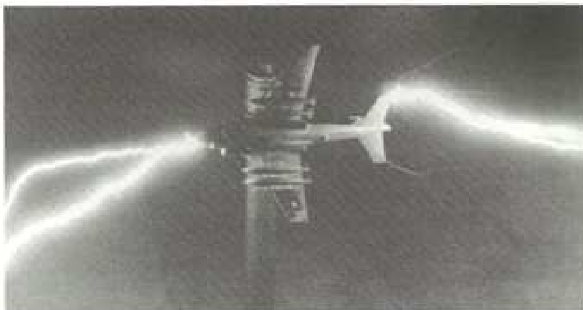
Zonas de anclaje del rayo en un modelo de Grumman A-6 Intruder.
