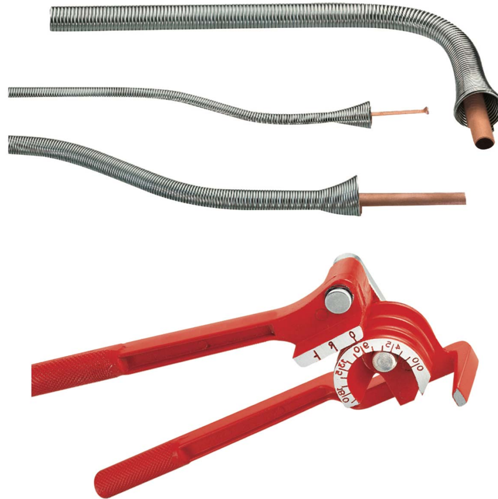
Figura 1.46. Muelles y curvatubos para el curvado de tubos. Cortesía de Rothenberger.
