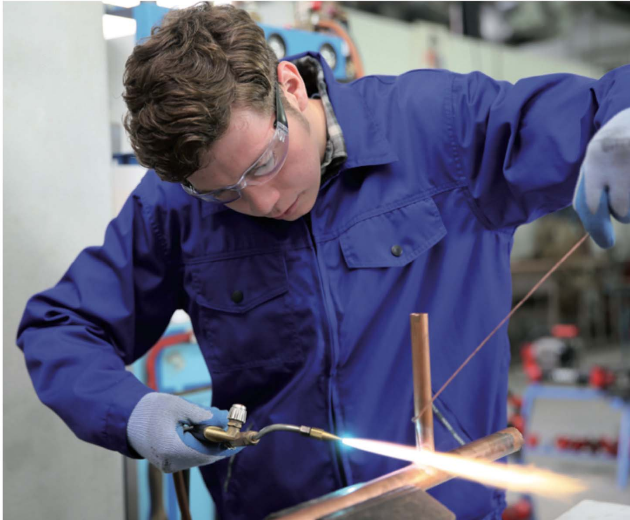
Figura 1.49. Soldadura fuerte en tuberías de cobre con soplete de oxibutano.
