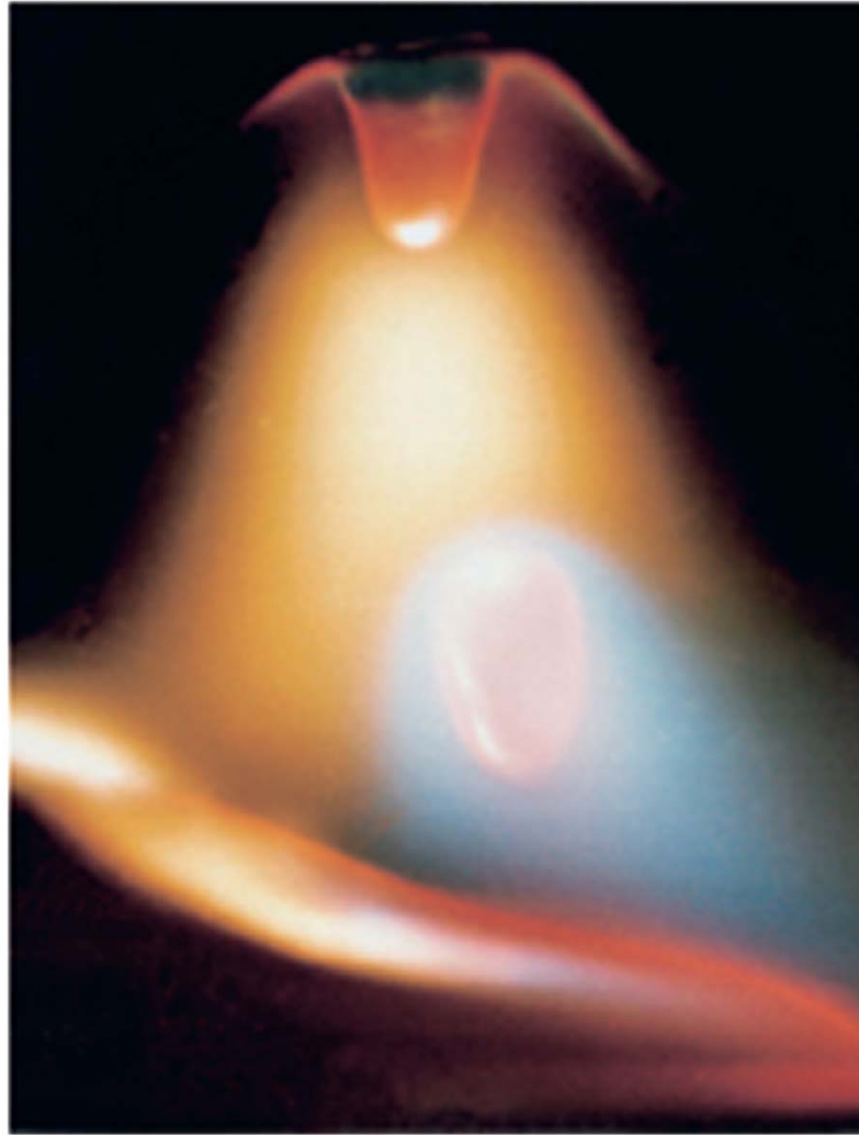
Figura 7.5. Detalle de fusión de electrodo con gotas de metal fundido.
