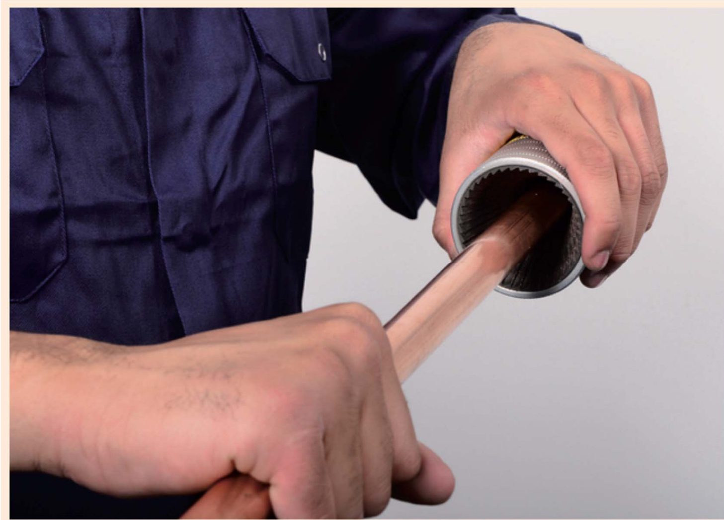
Figura 7.46. Retirada de rebabas sobrantes con escariador. Cortesía de IBP Atcosa.
