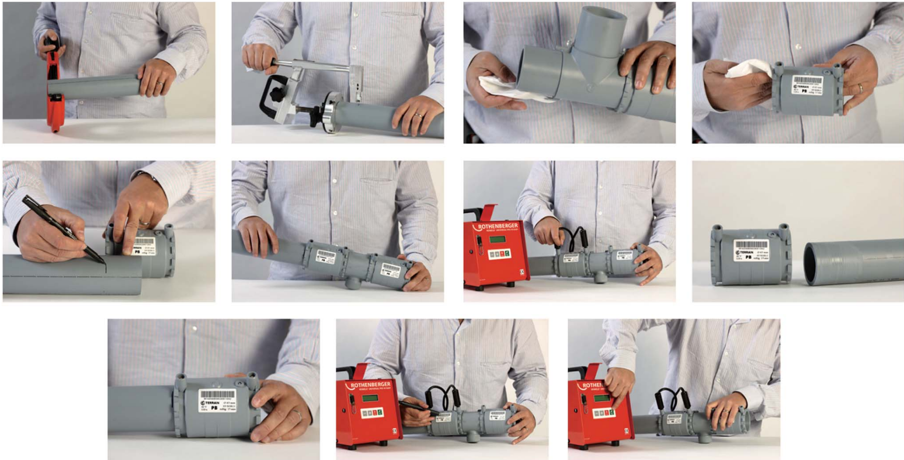
Figura 7.65. Proceso de unión de tubos de polibutileno por electrofusión.
