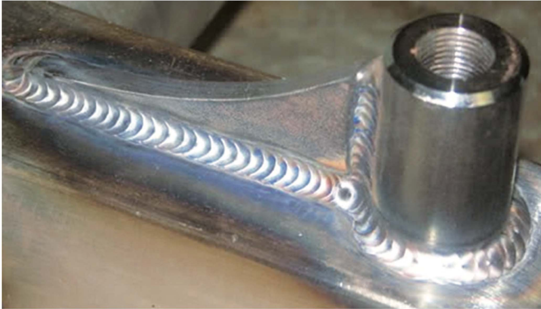
Figura 7.42. Ejemplo de soldadura TIG.
