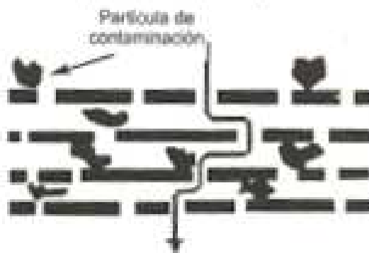
Fig. 33.16a Filtración en superficie (arriba) y en profundidad (ilustración inferior)
