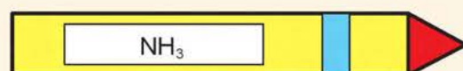
Figura 5.11. Señal para la identificación de la tubería de aspiración de la instalación con amoníaco
