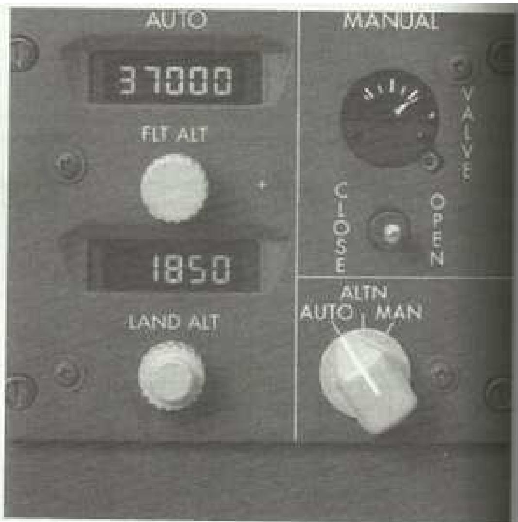
Fig. 38-22 Panel de control de un regulador de presión de control digital.
