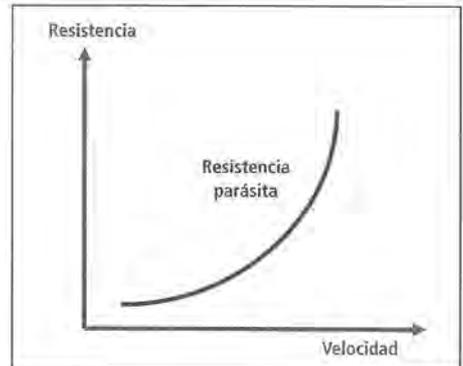
Figura 8.2.35. Resistencia parásita en función de la velocidad
