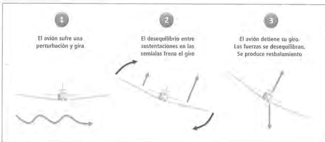
Figura 2.4.9. Comportamiento del avión ante una perturbación.
