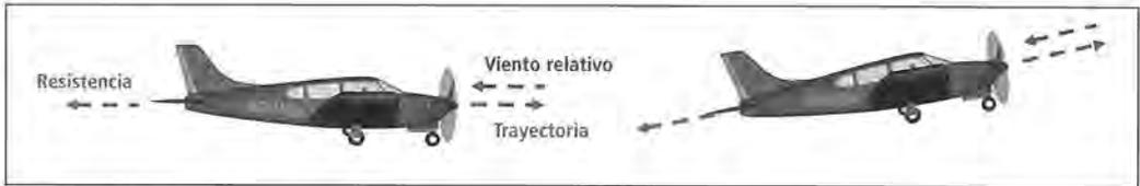
Figura 8.2.34. Dirección y sentido de la resistencia
