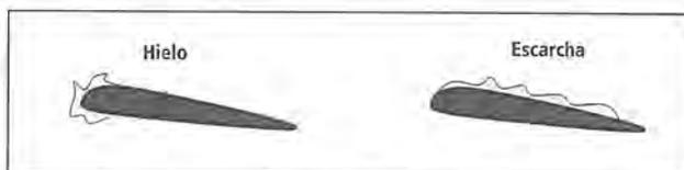
Figura 8.2.53. Formación de hielo y escarcha en las alas
