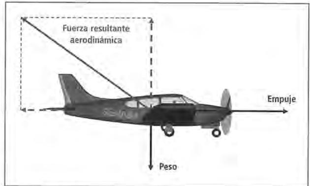
Figura 8.2.43. Fuerzas sobre el avión y resultante aerodinámica
