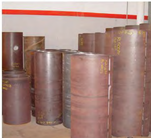
Figura 22. Virolias de chapa de acero enrolladas.
