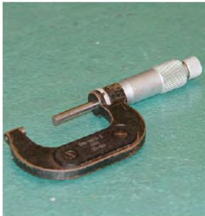
Figura 11 Detalle nonio micrómetro.
