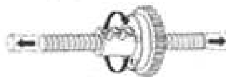
Fig. 35.31 Esquema del sistema de control con modo de actuación eléctrico A Interruptor; B Motor eléctrico; C Husillo; D Tuerca; E Superficie de control; F Corona dentada
