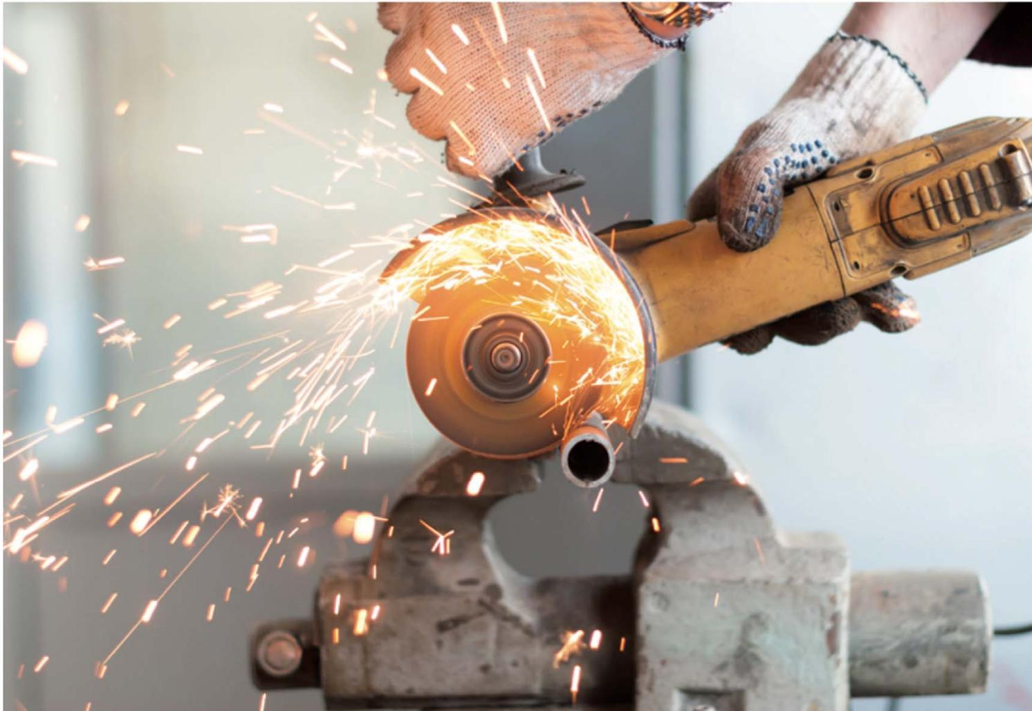
**Figura 8.2.** Corte de tubería con radial.
