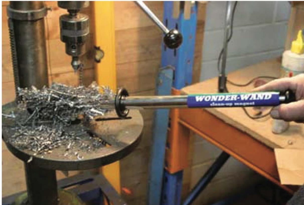
**Figura 8.21.** Retirada de virutas mediante útiles magnéticos.
